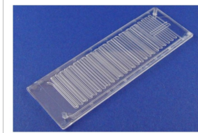
オンチップPCR チャンバの小型化と並列化により高速のPCRを実現。 連続流PCRコンセプトでは、チップ全体の温度の上げ 下げを行わずにPCRを実施。 蛍光リアルタイム検出装置ChipGenie edition TSOシリ ーズをカタログ掲載。 ■ 詳細ページ: PCR
