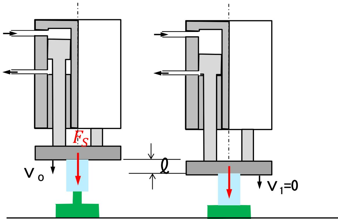
ワーク接触後、反力により下降速度が減速する場合
