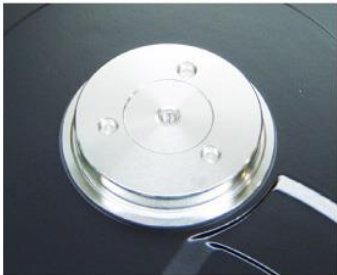
ハードディスクのプラッター(磁気ディスク)を回転させるスピンドルモーターは、プラッタ取り付け軸および軸受が一体化した構造になっており、部品点数の低減による生産性の向上とコストダウンの両立を実現しています。
